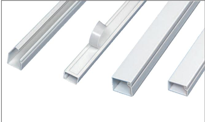
Der selbstklebende Mini-Installationskanal wird mit dem Scharnierdeckel extrudiert. Das Klebeband ist aus hochwertigem beschichtetem Schaumstoff und hat eine hohe Haftkraft. Ideal geeignet auch auf unebenen Oberflächen und Wänden. Zusätzlich kann der Kanal verschraubt werden.
